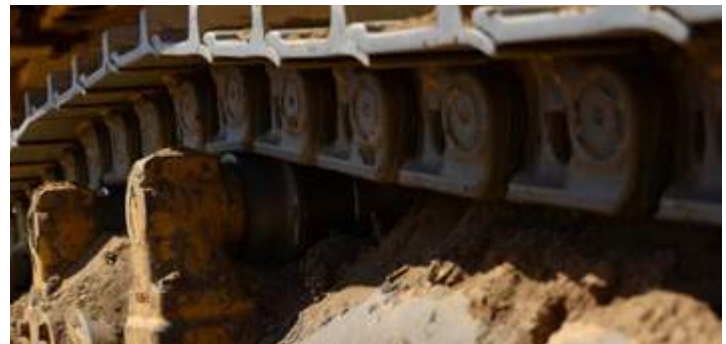
Detail of the track chains during inspection at 2400 working hours. Détail des chaînes d’entraînement pendant l’inspection à 2400 heures de travail.
