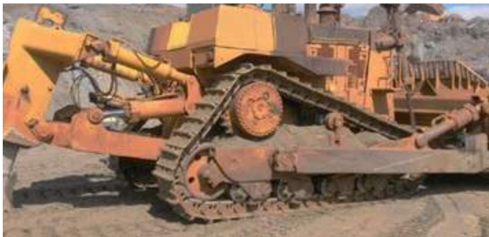
The machine stopped during undercarriage measurement at 1200 working hours. La machine s’est arrêtée pendant la mesure du train de roulement à 1200 heures de travail.
