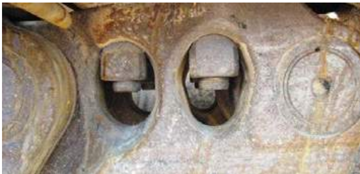
Detail of track chain during inspection at 1500 working hours. Détail des chaînes d’entraînement pendant l’inspection à 1500 heures de travail.
